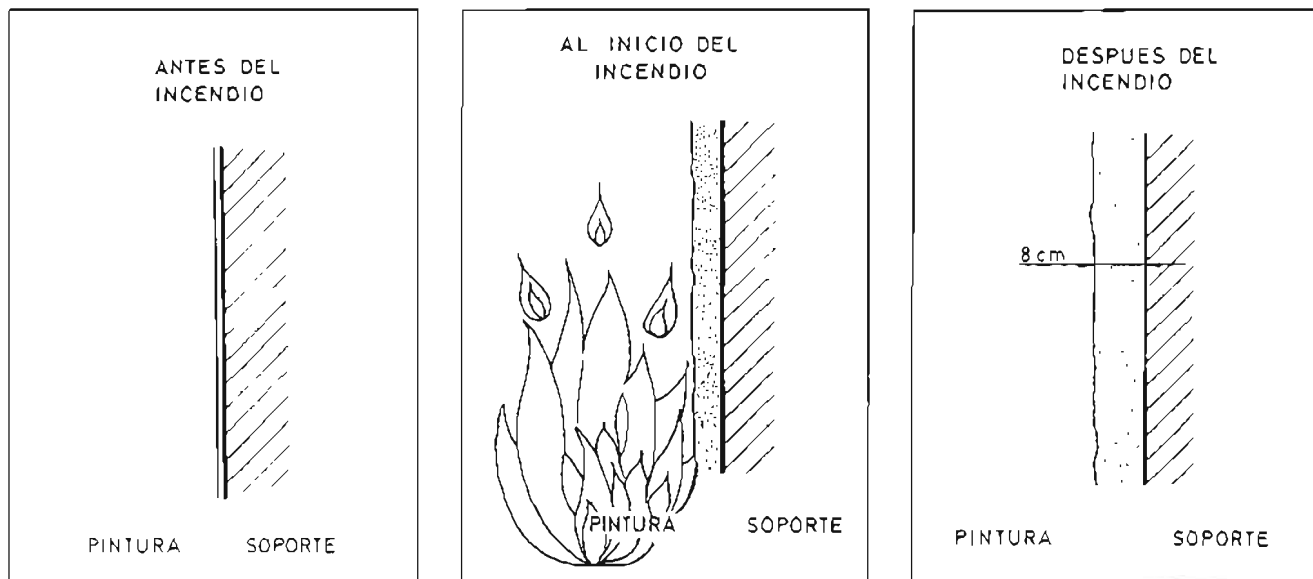
FIGURA 10. Comportamiento de los recubrimientos en un incendio.
