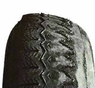
Fig. 14.—Banda con desgaste excesivo y desigual por mal paralelismo en el tren delantero.
