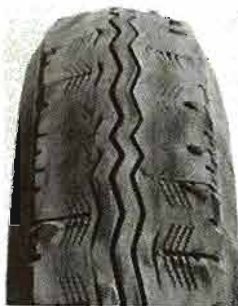
Fig. 13.—Estado de la banda de rodamiento por mal trato.
