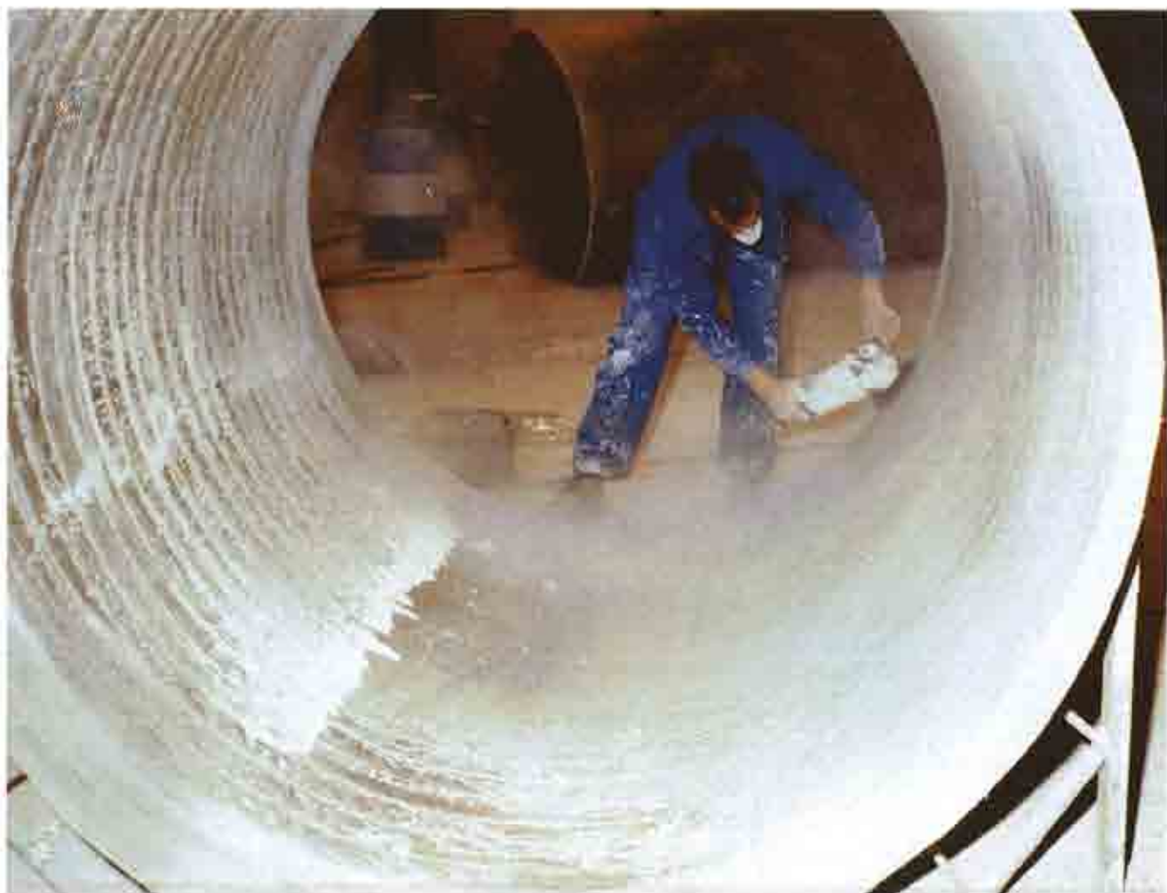
Tratamiento por abrasión de la superficie de contacto previo al ensamblado de piezas.
