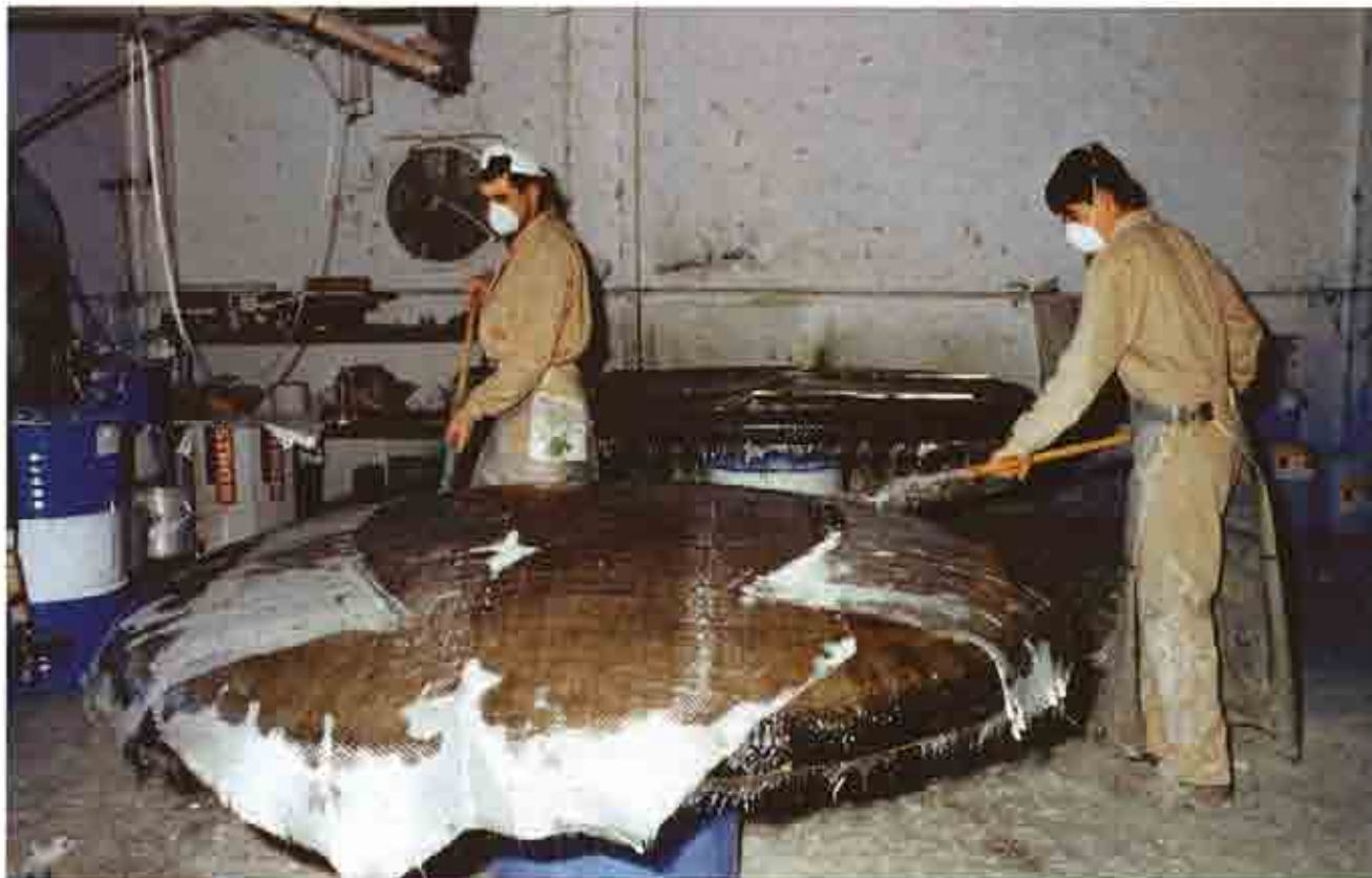
Aplicación manual sobre el molde del tejido y resina.
