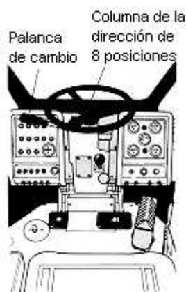
**Fig. 6: Mandos pala cargadora sobre ruedas (Fuente Caterpillar)**
