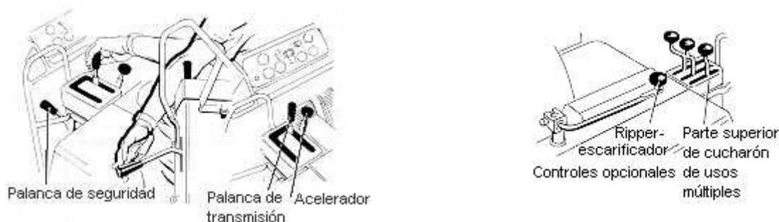
**Fig. 5: Mandos pala cargadora sobre orugas (Fuente Caterpillar)**
