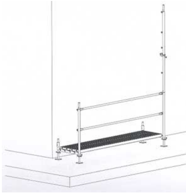
Figura 6 Instalación del marco parcial en L
