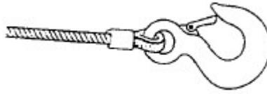
**Figura 10. Extremo del cable anclado al pescante**
