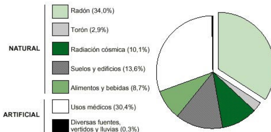
Fig. 1: Contribución de las distintas fuentes de exposición, de origen natural y artificial, a la dosis recibida por la población.
