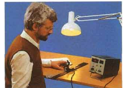
Fig. 4. Dispositivo típico para medidas de contraste en mesas, el avance del carro varía automáticamente el ángulo de incidencia del transductor y gira el patrón de contraste.
