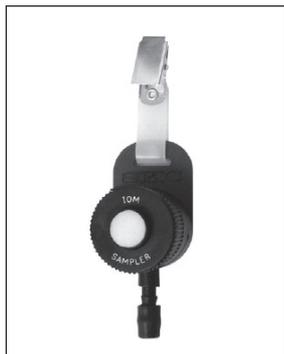
Figura 11. Muestreador IOM multifracción
