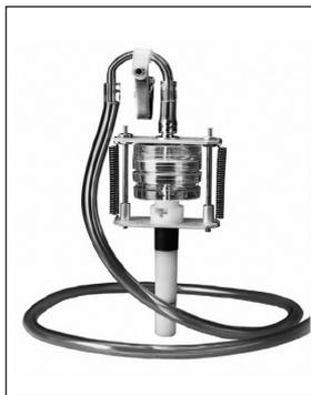
Figura 4. Ciclón de nylon 10 mm
