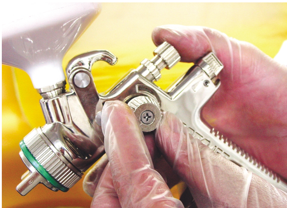
Regulación de la pistola aerográfica
