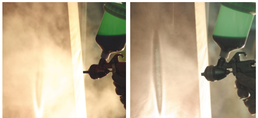
Pulverización con pistola convencional y con pistola de alta transferencia
