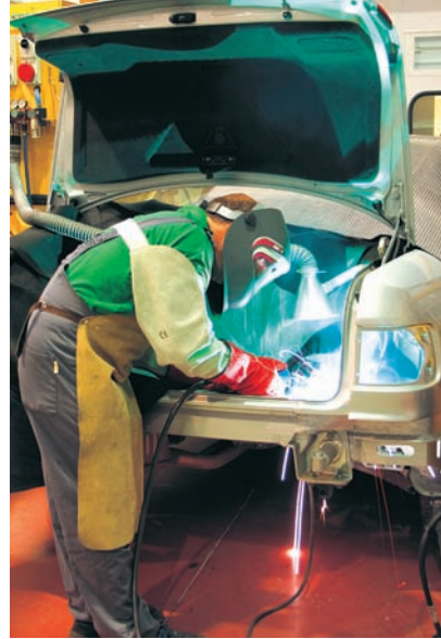
Equipos de protección: guantes, manguitos, polainas , peto pantalla facial y extractor de gases
