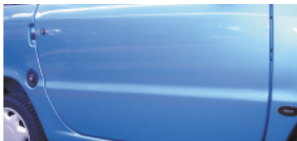
Empleo de molduras y resaltes para el pintado parcial
