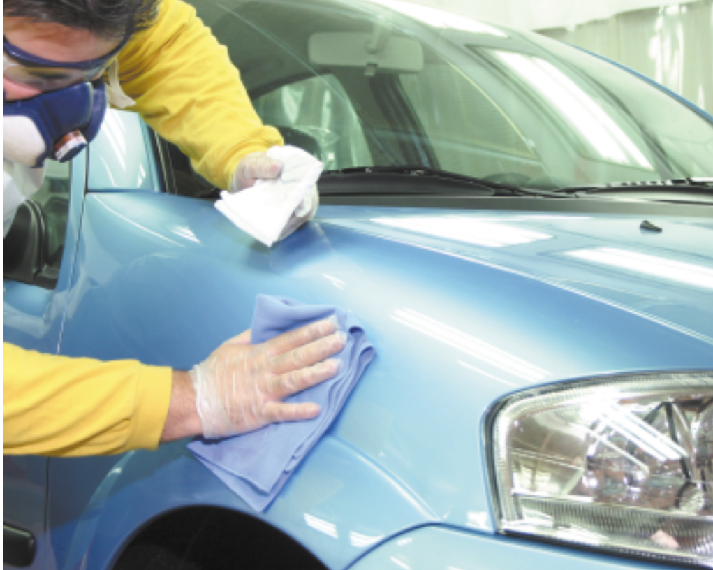
Abrillantado a mano de la zona de unión
