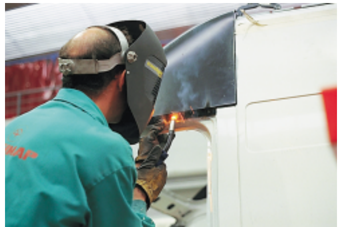
Soldadura de terminales triangulares
