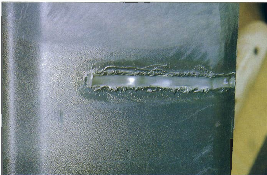
Soldadura realizada con alta temperatura.
