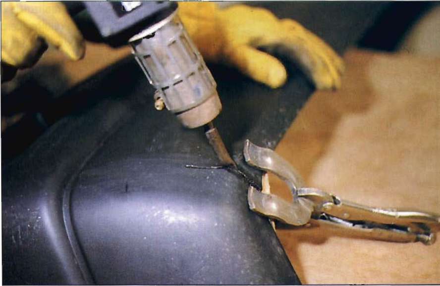
Pegado de bordes con boquilla en cuño.
