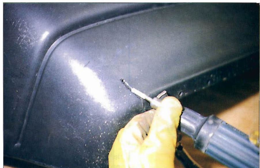
Practicando una ranura o bisel para soldar.
