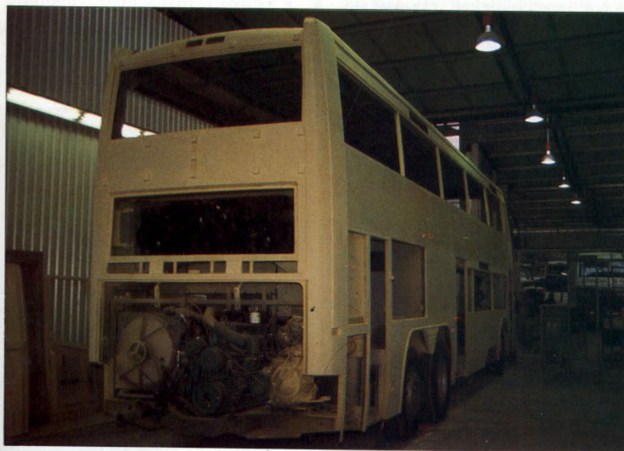
Las imprimaciones epoxi pueden ser utilizadas en el pintado de vehículos industriales
