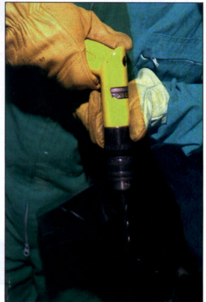
Ejecución de un taladro en una pieza de chapa.
