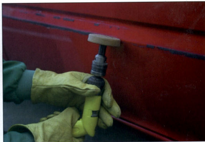
Eliminación de restos de adhesivos de molduras decorativas.
