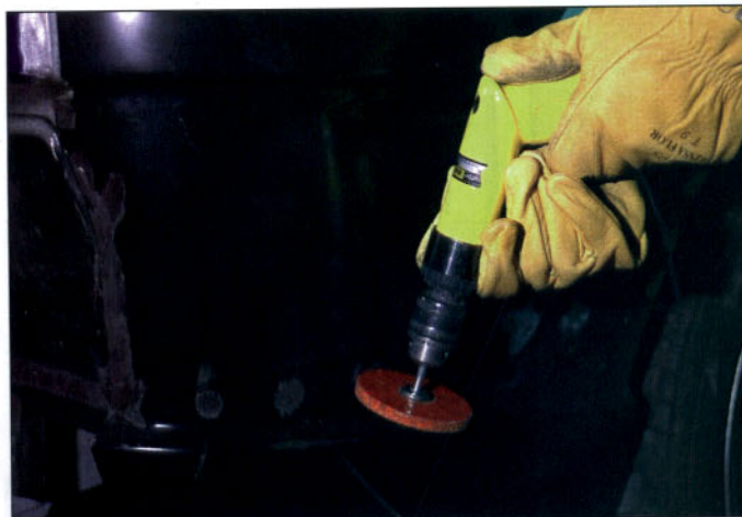
Eliminación de cataforesis con disco de alambre impregnado.
