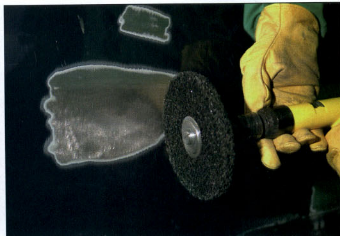
Eliminación de pintura con disco Clean 'N Strip.
