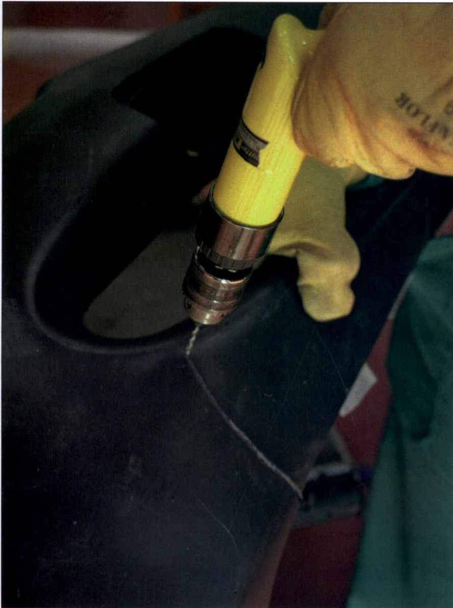
Empleo del taladro en la reparación de paragolpes.
