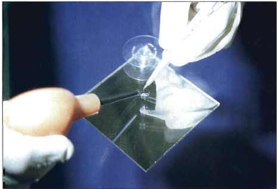
Eliminación del vidrio suelto.
