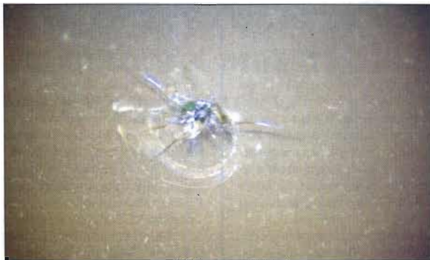
Daño típico producido por impacto.
