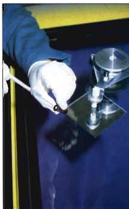
Vertido de la resina en el inyector.
