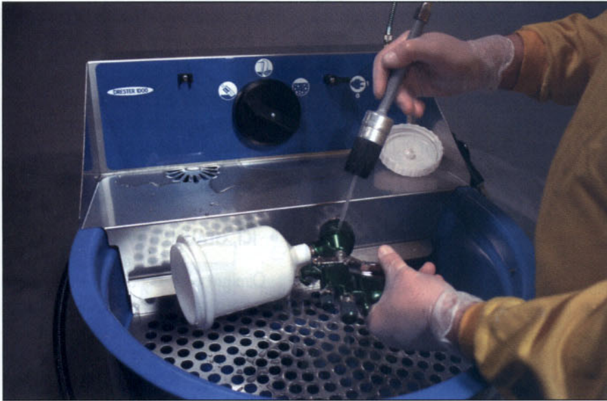
Limpieza de pistola en máquina lavadora para equipos de aplicación de pinturas al agua.
