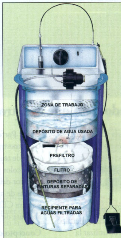
Esquema de funcionamiento de una lavadora de pistolas, modelo DRESTER 1000.
