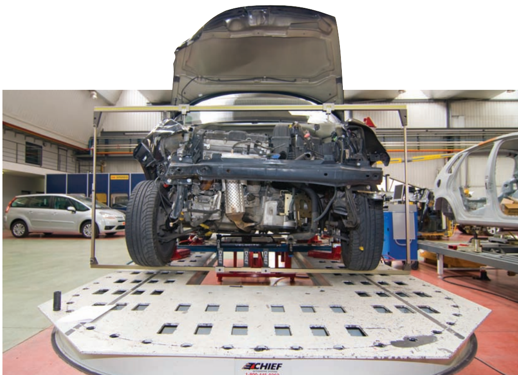
Medición de las torretas de suspensión
