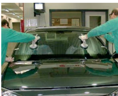
Colocación de la luna
