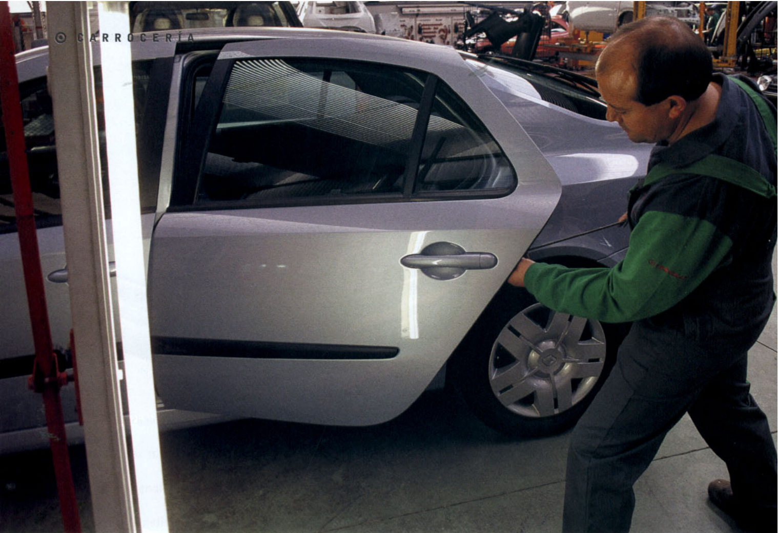
Reparación mediante técnica de empuje
