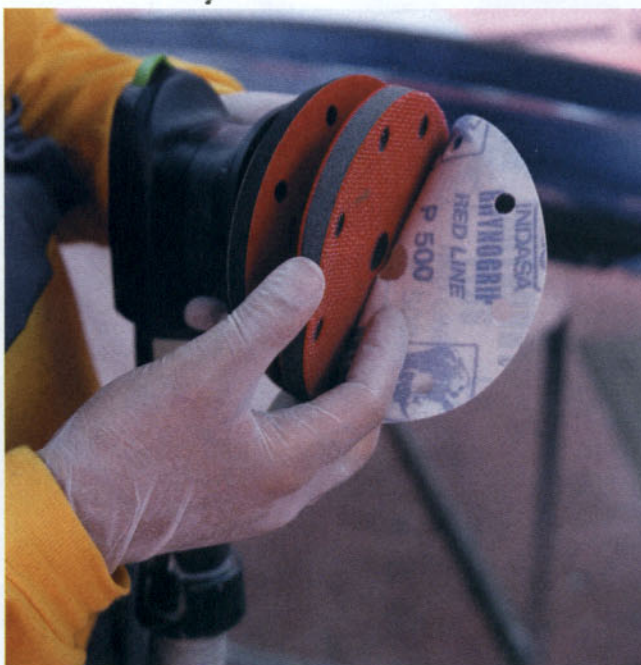
Colocación del soporte extrablando
