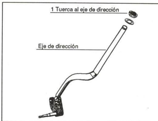
Figura 25.- Fijación del eje de dirección
