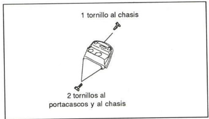
Figura 23.- Fijación de la tapa de depósitos de gasolina y aceite
