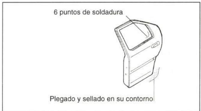
Figura 34.- Unión del panel de puerta trasera
