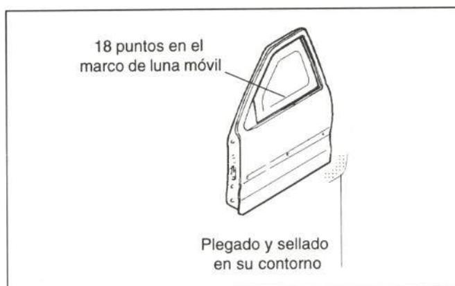
Figura 30.- Unión del panel de puerta
