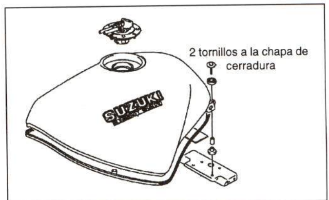
Figura 27.- Unión del depósito de combustible
