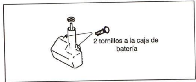
Figura 30.- Unión del depósito de agua
