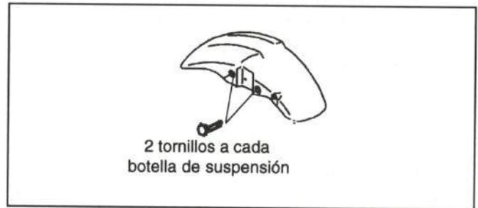
Figura 36.- Unión del guardabarros delantero
