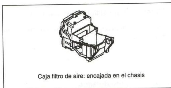
Figura 35.- Unión de la caja filtro de aire
