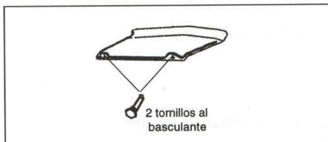
Figura 25.- Unión del cubrecadenas
