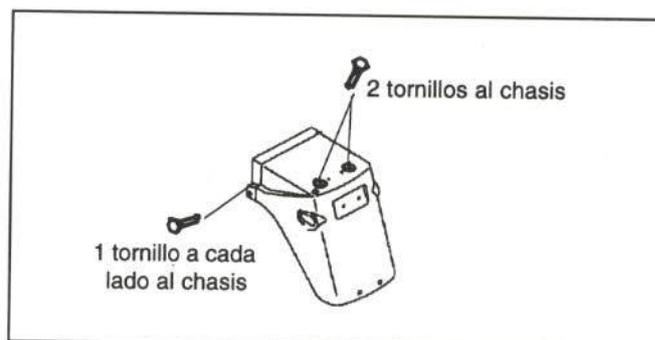
Figura 22.- Unión del portamatrículas
