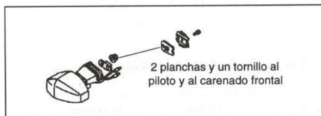
Figura 31.- Unión del intermitente delantero
