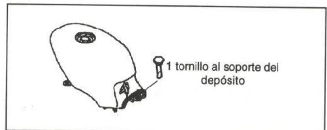
Figura 28.- Unión del depósito de combustible
