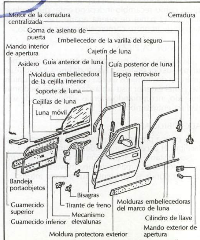
Fig. 29.—Elementos de la puerta delantera.
