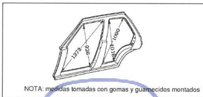
Figura 7.- Medidas de los huecos de puertas
