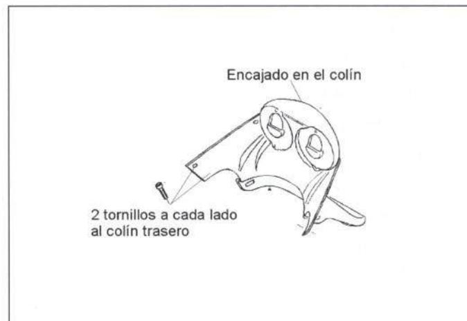
Figura 18.- Unión del portamatrículas
