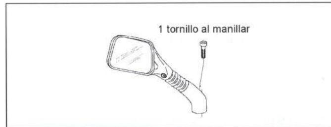
**Figura 29.-** Unión del espejo retrovisor
