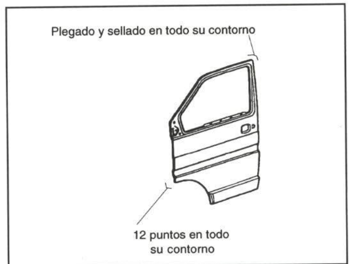
Figura 30.- Unión de paneles de puerta.
