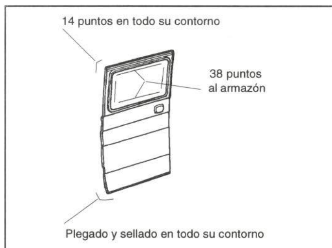
Figura 43.- Unión del panel exterior
