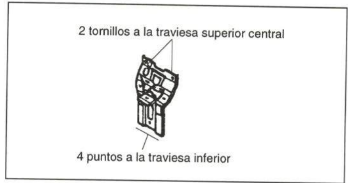
Figura 21.- Unión del soporte central con la carrocería
