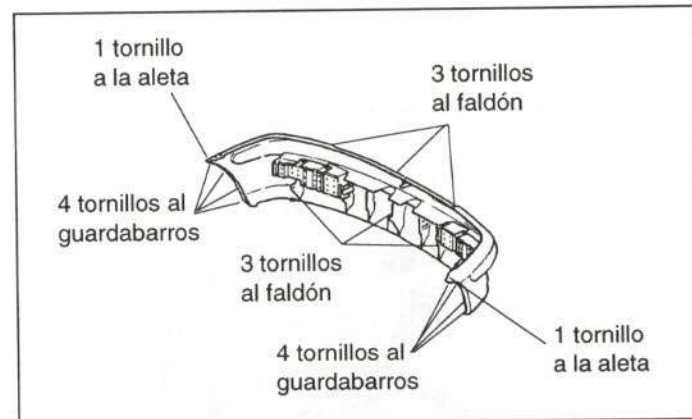
Figura 43.- Unión del paragolpes trasero
