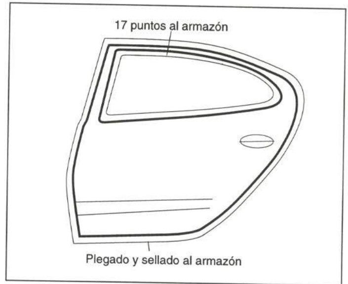
Figura 37.- Unión del panel de puerta trasera
