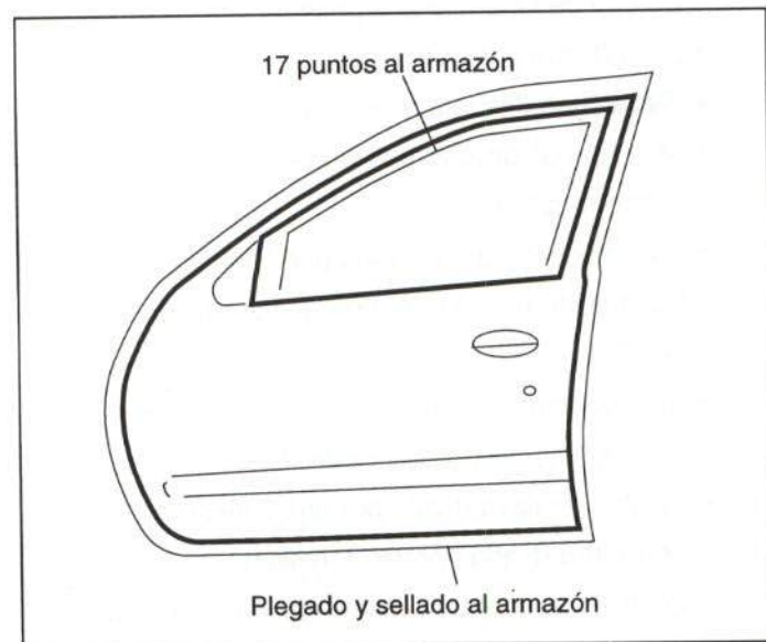
Figura 34.- Unión del panel de puerta delantera
