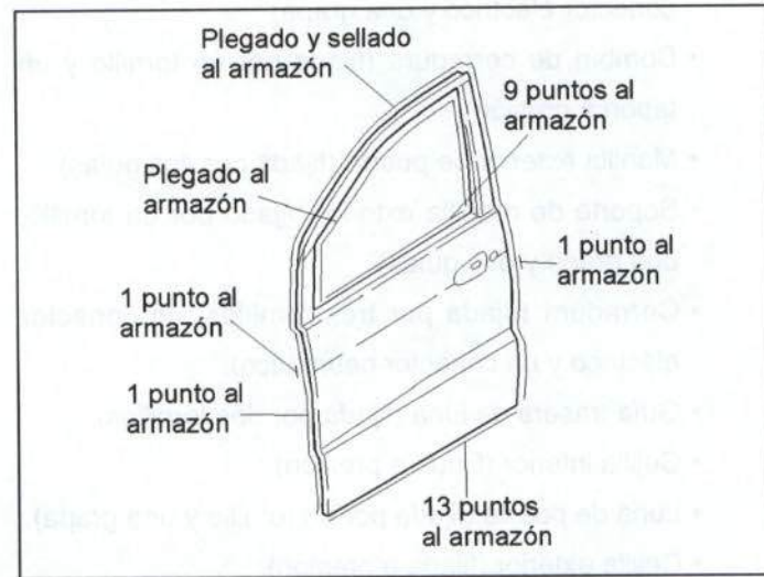
Figura 30.- Unión del panel de la puerta delantera
