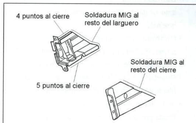
Figura 25.- Unión de la punta de larguero delantero
