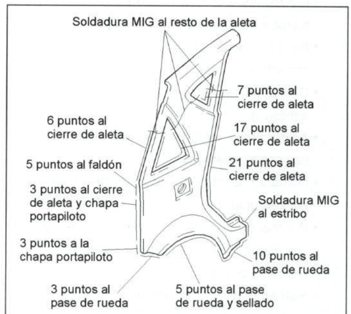
Figura 40.- Unión de la aleta trasera
