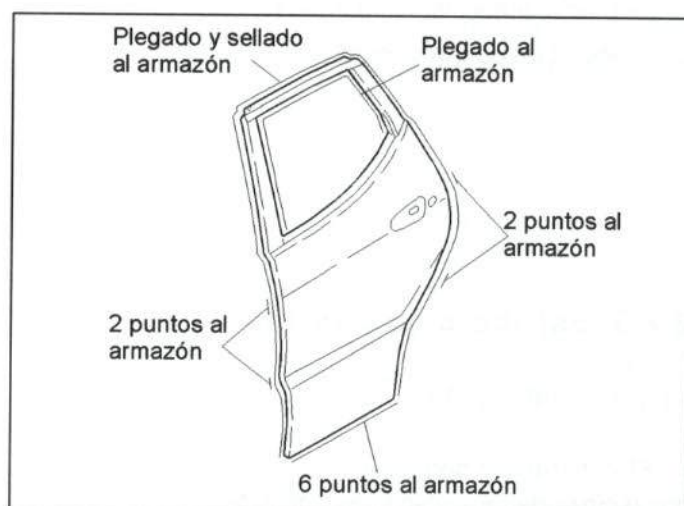
Figura 33.- Unión del panel de la puerta trasera
