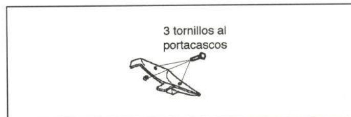
Figura 18.- Unión de la tapa de batería
