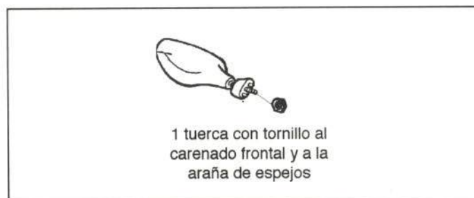
Figura 30.- Unión del espejo retrovisor
