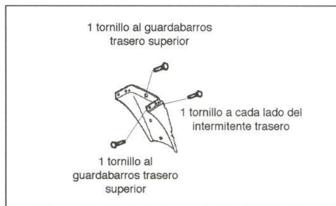
Figura 23.- Unión del portamatrículas
