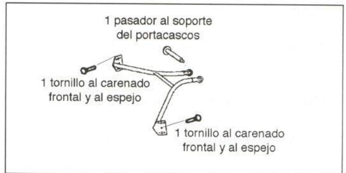
Figura 32.- Unión de la araña de espejos
