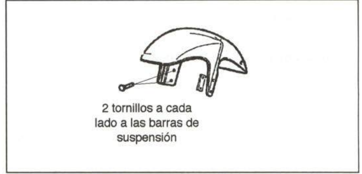
Figura 36.- Unión del guardabarros delantero
