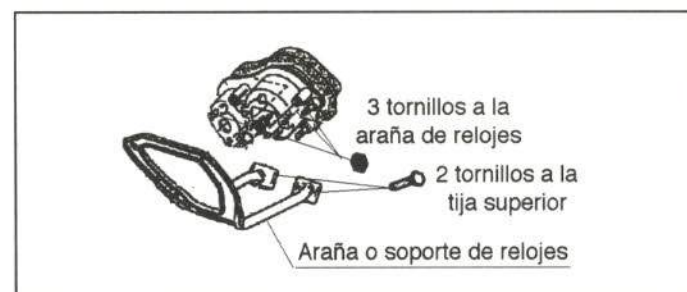
Figura 35.- Unión del cuadro de relojes
