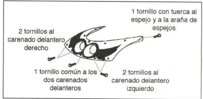
Figura 31.- Unión del carenado frontal
