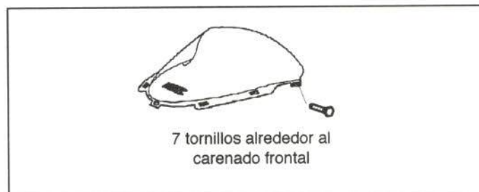
Figura 29.- Unión de la cúpula
