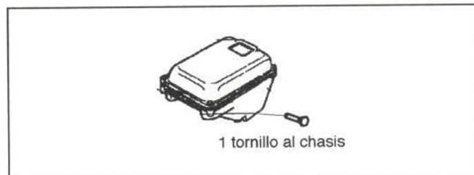
Figura 28.- Unión de la caja del filtro de aire
