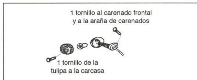
Figura 34.- Unión del intermitente delantero
