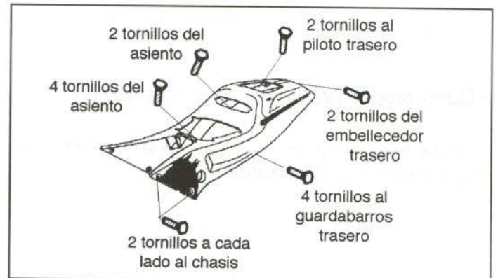
Figura 21.- Unión del portaequipajes
