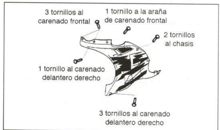
Figura 33.- Unión del carenado delantero
