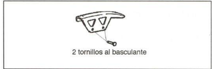
Figura 26.- Unión del cubrecadenas
