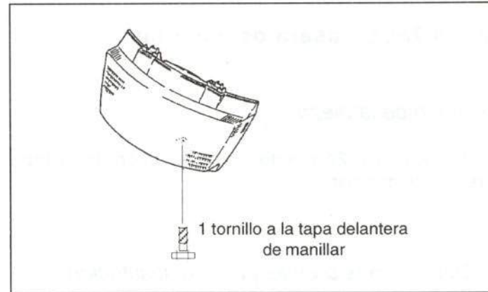
Figura 26.- Unión del faro delantero
