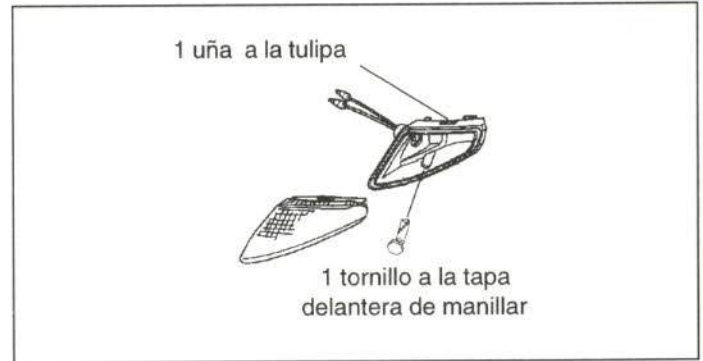
Figura 28.- Unión del intermitente delantero izquierdo
