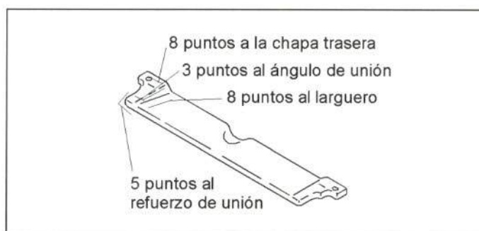
Figura 27.- Unión de la traviesa inferior
