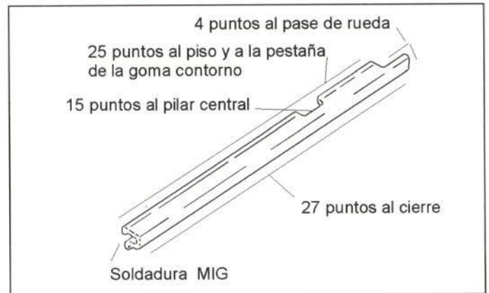
Figura 43.- Unión del estribo bajo puerta
