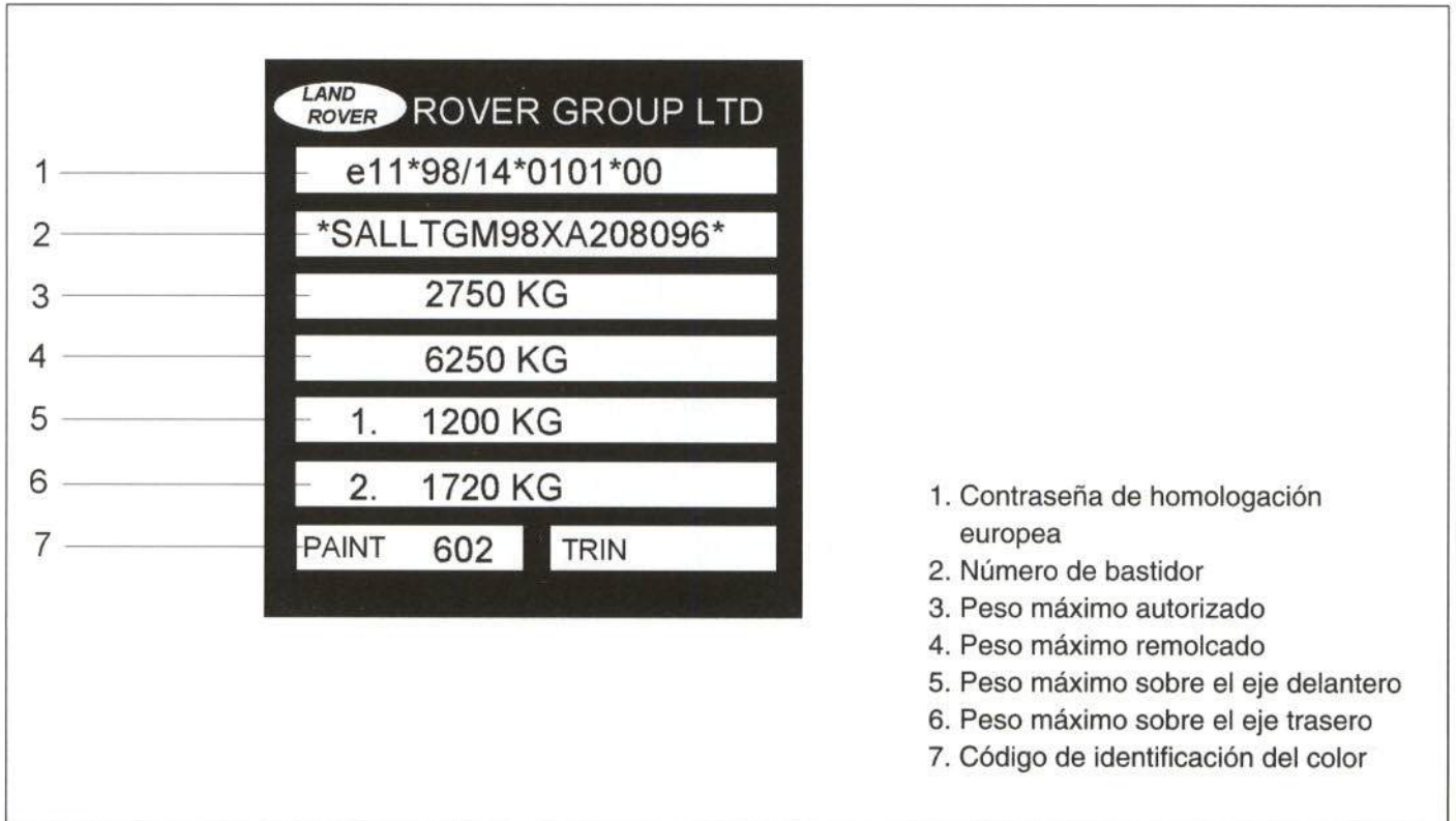
Figura 2.- Placa del constructor
