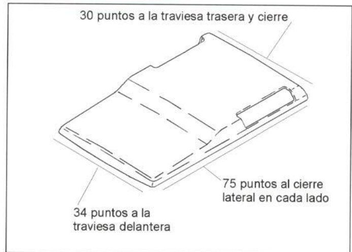
Figura 45.- Unión del techo
