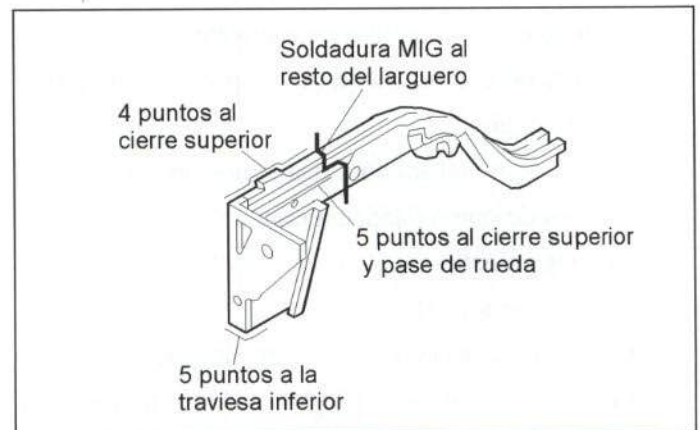
Figura 27.- Unión de la sección del larguero delantero
