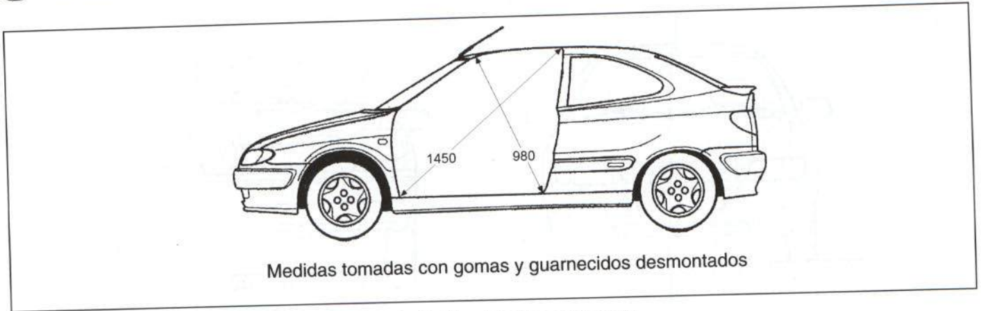
Figura 6.- Medidas de los huecos de puerta
