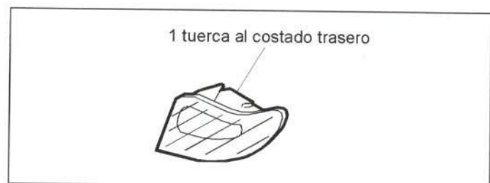
Figura 37.- Unión del piloto trasero
