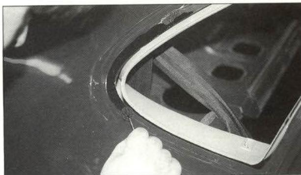
**3.5.** Preparación de la pistola de aplicación de poliuretano, realizando un corte triangular en la boquilla del cartucho de adhesivo, de una altura 1 ó 2 mm superior a la del marco de la luna.
