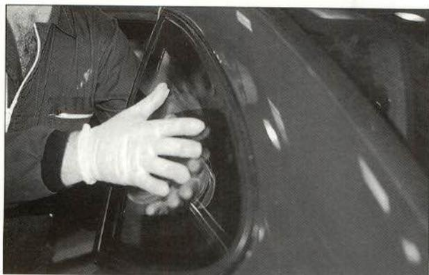
**3.8.** Colocación de una eslinga de presión con ventosas que apoyen sobre la propia luna, con el objeto de soportar la luna enrasada con su marco, pero sin presionar demasiado. El tiempo aproximado de secado (aunque idealmente sea de 24 horas) depende del tipo de adhesivo utilizado; si es mono-
