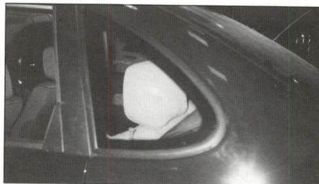
**NOTA:** Conviene aprovechar los tiempos de evaporación y secado del desengrasante y de la imprimación de poliuretano, respectivamente, para montar los accesorios de la luna de custodia, pues la eslinga de presión que se coloca posteriormente impedirá llevar a cabo esta operación.
