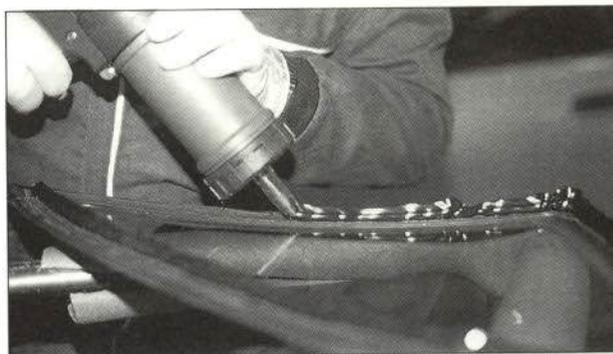
**3.7.** Colocación de la luna de custodia sobre su marco, apoyándola primeramente en la parte anterior para guardar el ajuste con la puerta trasera.
