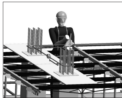
Figura 14. Detalle de tensado con la carraca de vida a ferralla
