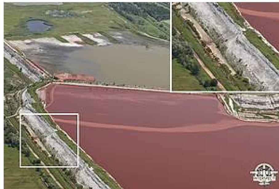
Una fotografía aérea de Junio de 2010 muestra claramente el adelgazamiento y la filtración en el muro de la balsa de lodos de Kolontar, tres meses antes de que este colapsara matando a siete personas y cubriendo 40 Km2 con lodo tóxico y produciendo una pluma de contaminación cáustica río abajo hacia del Danubio... Esta nueva prueba,... debería ser motivo para una investigación urgente, no ya del desastre, sino de la situación de otras balsas similares...
