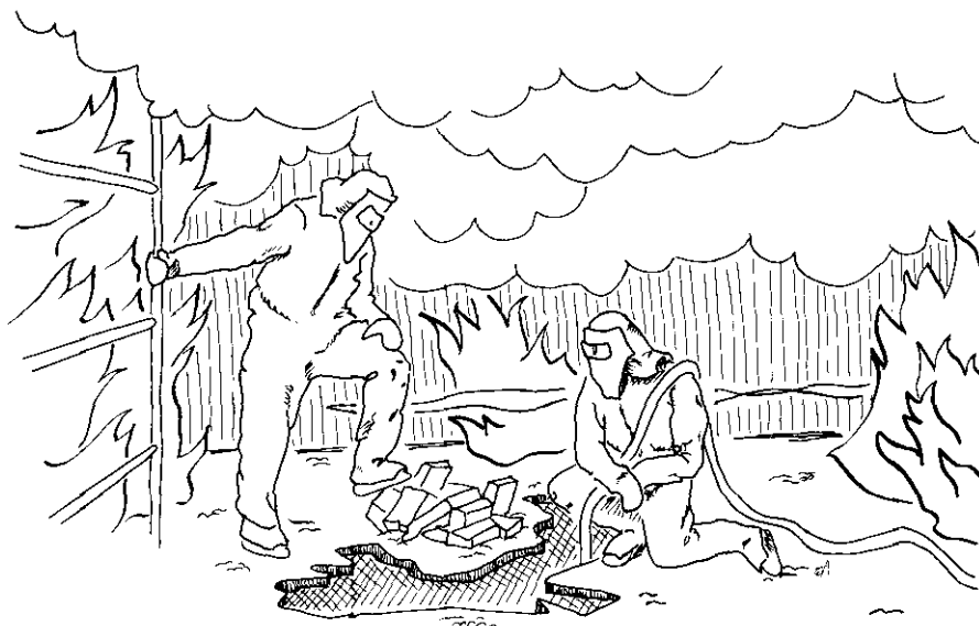
FIG. 23. SE ESTA INYECTANDO ESPUMA EN EL PISO INFERIOR. LAS PERSONAS PERMANECEN AGACHADAS, SIEMPRE DEBAJO DEL HUMO. EL AIRE QUE SE DESALOJA DEL SOTANO A CONSECUENCIA DE LA ESPUMA HACE QUE LA ATMOSFERA SE MANTENGA RESPIRABLE PARA AMBOS.
