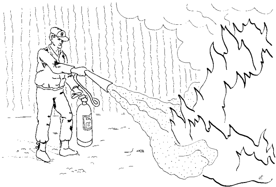
FIG. 21. DEBEMOS DIRIGIR EL CHORRO DEL GAS A LA BASE DE LAS LLAMAS, QUE ES EL LUGAR DONDE TIENE LUGAR LA COMBUSTION. SOFOCADA ESTA TERMINARA EL INCENDIO.
