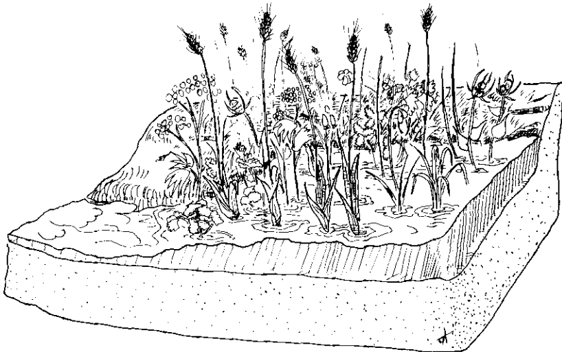
FIG. 48. LA VEGETACION QUE CRECE EN LAS ORILLAS, CAÑAVERALES, ES TAMBIEN, EN CASO DE RIADAS, OBSTACULOS PARA UN DESAGUE RAPIDO DE LAS AGUAS ACUMULADAS.
