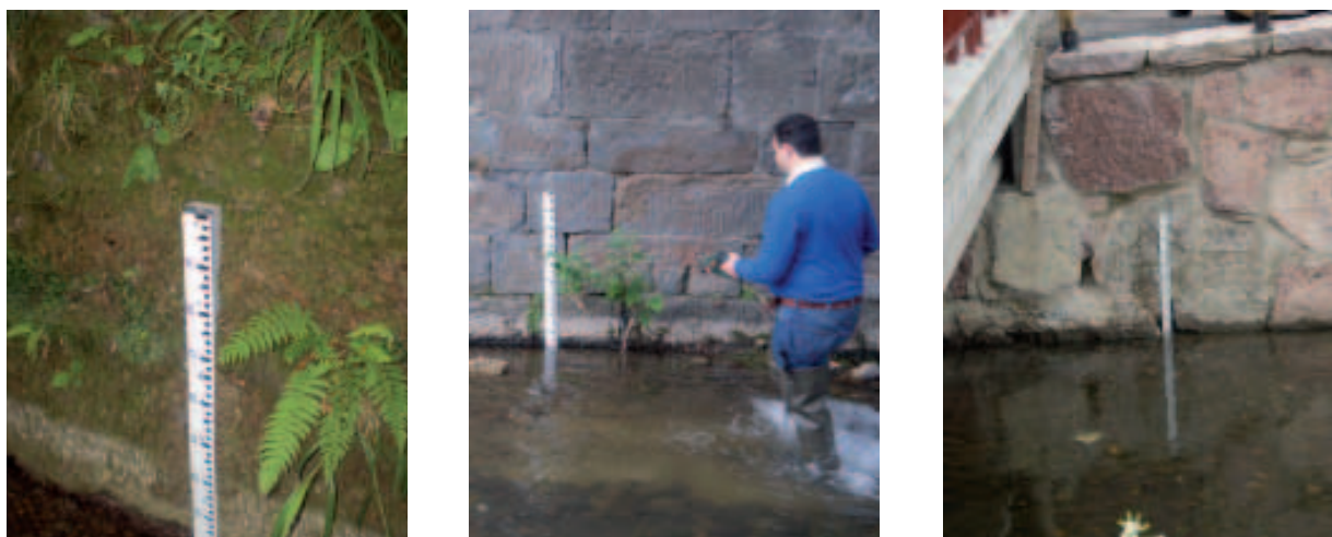
Figura 58. Escalas limnimétricas colocadas en las secciones de aforo del río Turón; de izda. a dcha.: La Granxa, La Veguina y Peñule
