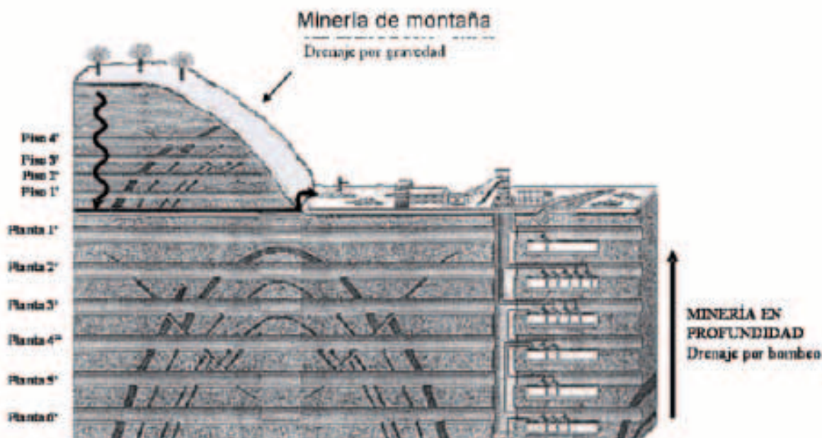
Figura 8. Esquema de labores mineras de extracción de carbón en la CCC
