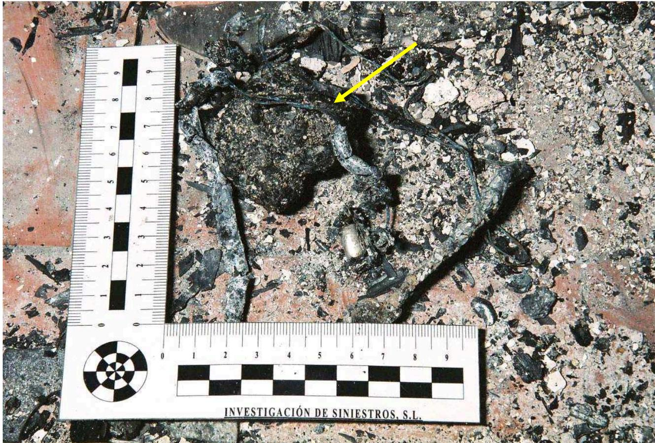
Cargador de móvil. La frecuencia de causa de incendio relacionada con este dispositivo va en aumento debido la reducción de costes de su fabricación y al mayor uso de teléfonos móviles.
