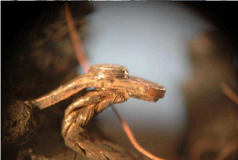
Fusión por calor interno en una pletina atornillada de uno de los magnetotérmicos
