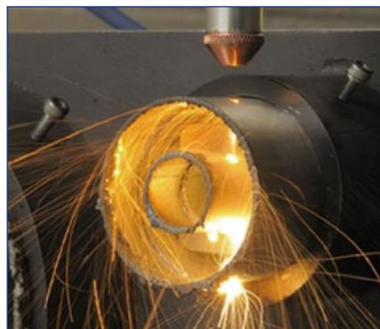
El láser corta a través de tubos de acero concéntricos (Foto: NEI Magazine)
