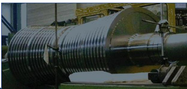
Turbina de alta presión (Foto: Siemens)
