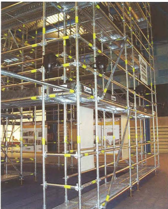
Figura 2.9 Detalle de nudo de un andamio normalizado multidireccional. (fuente: propia)
