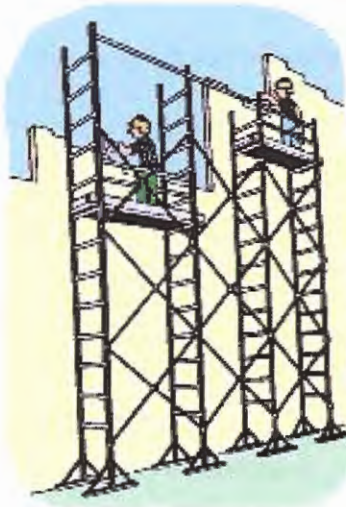
Fig. 2.8 Andamio arriostrado (fuente NTP 502)
