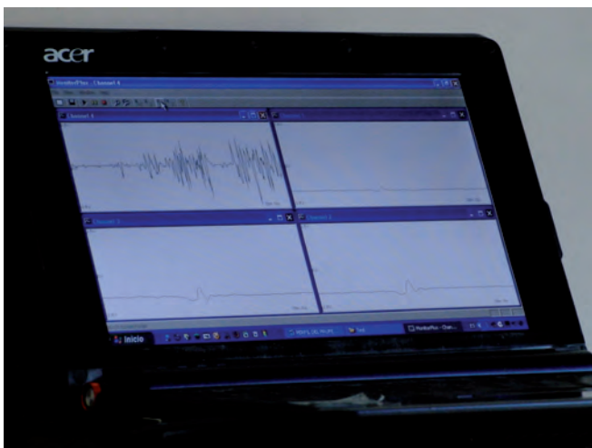
Figura 12. Las señales de EMG raw (señal sin filtrar) y aceleración en cada uno de los ejes cartesianos recogidas en la pantalla.
