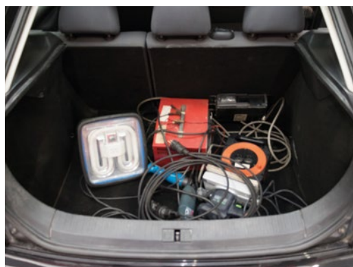
► Transporte inadecuado de herramientas y equipos
