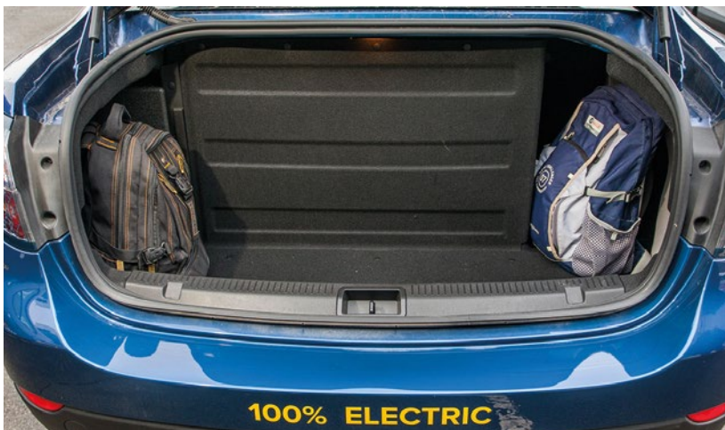
► Maletero del Renault Fluence Z.E, con la adaptación para alojar las baterías
