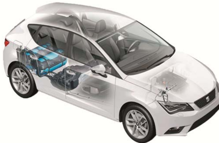
Gráfico 5. Esquema de un SEAT León TGI, vehículo bi-fuel.
