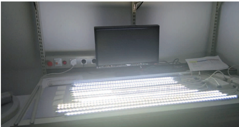
■ Figura 3 ■ Control de calidad en empresa de fabricación de luminarias LED (cortesía de LEC, S.L.)
